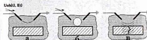
Рис. 3 а,б,в. Последовательность процессов пробоя жидкости и разрушения твердого тела при ЭГЛ (объяснения в тексте); Ueh(t) – импульс напряжения при пробое жидкости, I(t) – импульс тока
