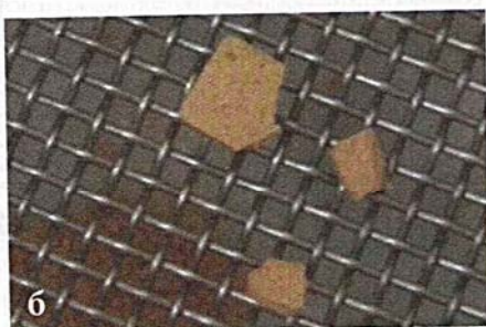
Рис. 5 а, б. Стадии разрушения образца искусственного «мочевого камня» при работе электрогидравлического литотриптора (объяснения в тексте)
