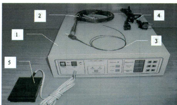
Рис. 1. Внешний вид прибора «Уролит-105М». 1 – корпус прибора, 2 – передающий кабель, 3 – зонд для литотрипсии, 4 – шнур электропитания, 5 – педаль.
